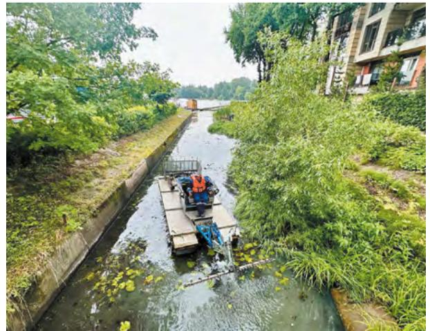
Он добавил, что уборка растений с водной поверхности выполняется в зависимости от степени зарастания водного объекта. На закрытых водоемах применяются специальные машины-амфибии с разнообразным навесным оборудованием, на судоходных реках используются катера, оснащенные косилками для резки водных растений. Вдоль берегов водных объектов в недоступных для плавсредств местах кошение производится вручную.
