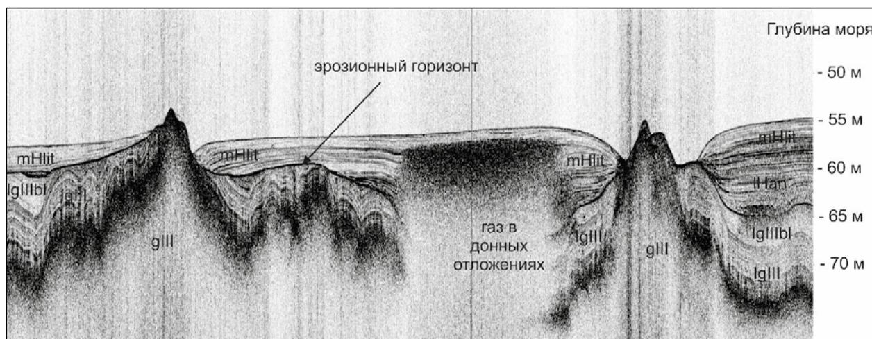
Рисунок 3. Фрагмент профиля непрерывного сейсмоакустического профилирования в восточной части Финского залива с изображением горизонта размыва между отложениями Балтийского ледникового озера и голоценовыми осадками. Условные обозначения: gIII – ледниковые отложения (морена); IgIII – ленточные глины; IgIIIbl – глины Балтийского ледникового озера; II fan – отложения Анцилового озера; mHlit – отложения Литоринового и современного Балтийского моря
